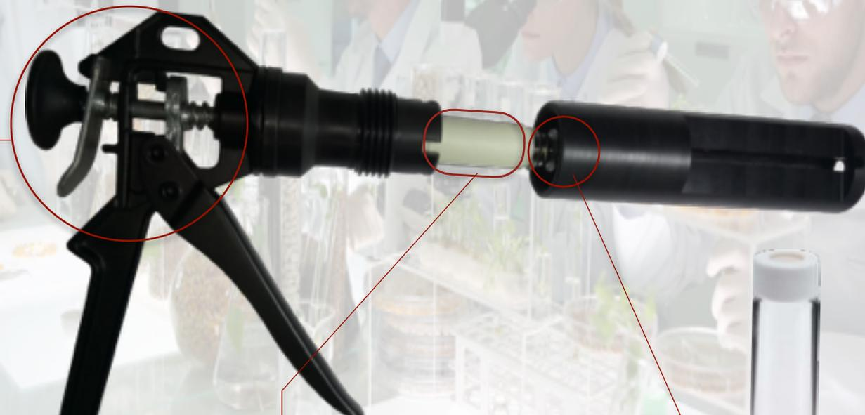
Gatilho mecânico, utilizado para acionar o embolo para extração da amostra.
